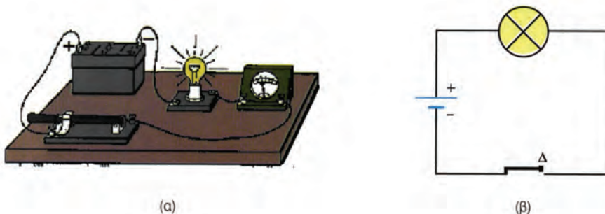
Εικόνα 10. Ηλεκτρικό κύκλωμα. (α) Εργαστηριακή διάταξη. (β) Συμβολισμός.
