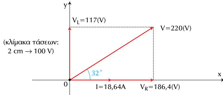
από το οποίο φαίνεται ο επαγωγικός χαρακτήρας του κυκλώματος καθότι η τάση προηγείται του ρεύματος κατά γωνία  $\varphi \approx 32^\circ$ .
