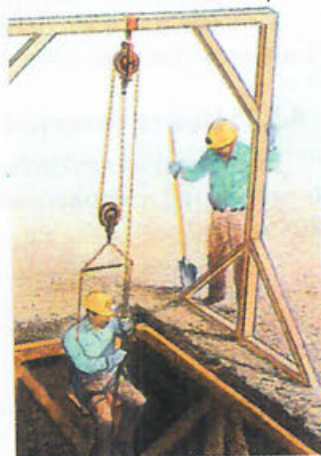
Εικόνα 5.9: Συνδυασμός ακίνητης και κινητής τροχαλίας (πολύσπαστο)
