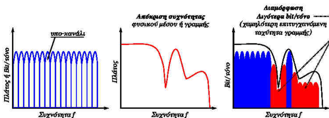
Εικόνα Π.3.α: Διαμόρφωση Διακριτής Πολυτονίας (DMT)
