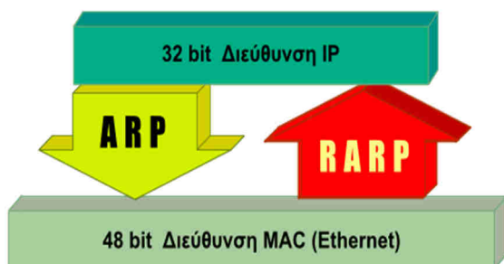
Εικόνα 3.3.στ: Σχέση ARP/RARP και διευθύνσεων
