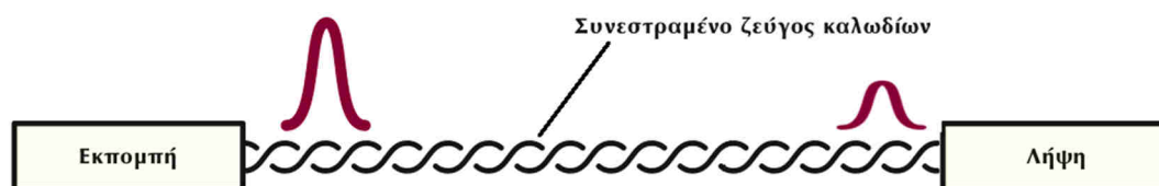
Εικόνα 2.4.1.θ: Εξασθένιση (Attenuation, Insertion Loss).
