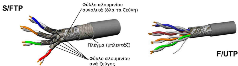
Εικόνα 2.4.1.η: Θωρακισμένα καλώδια συνεστραμμένων ζευγών.
