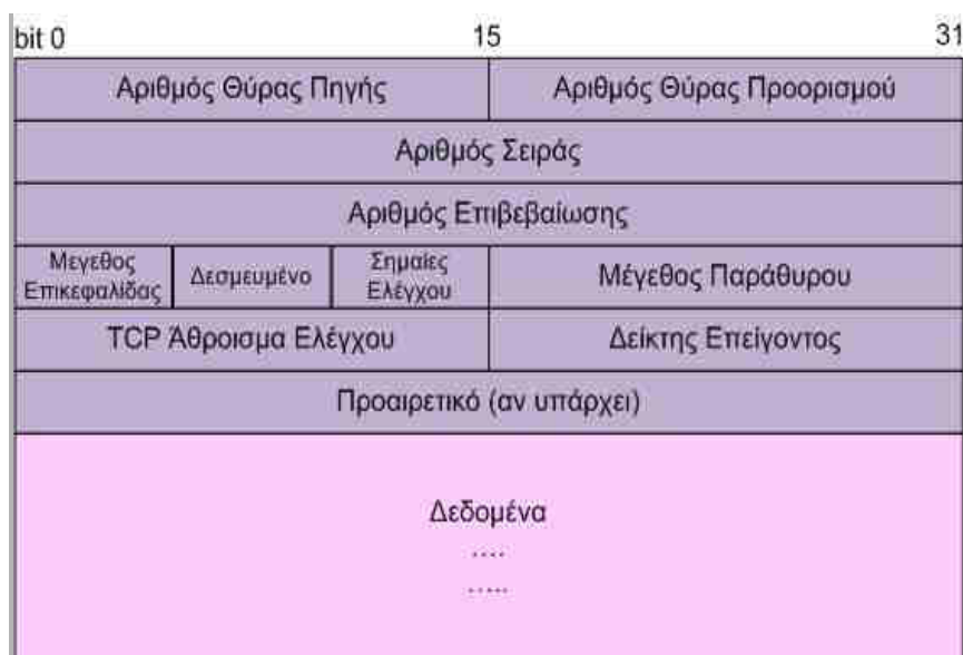
Εικόνα 4.1.1.γ: Πεδία της επικεφαλίδας ενός TCP τμήματος.
