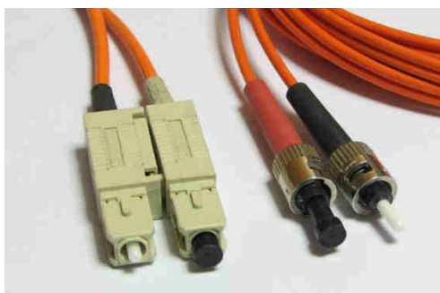
Εικόνα 2.4.1.κε: Συνδετήρες οπτικών ινών (SC, ST)
