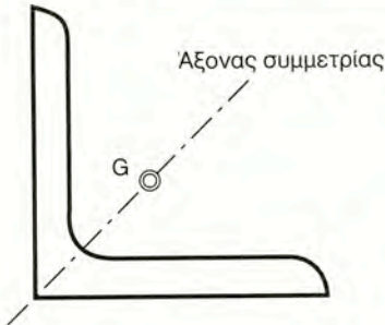
Σχήμα 4.2γ Κεντροειδές σχήματος με ένα άξονα συμμετρίας
