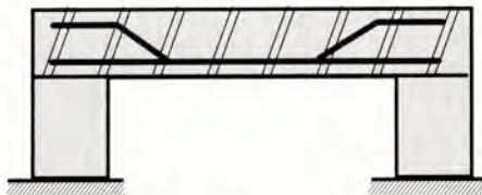
Σχήμα 10.45 Τοποθέτηση χάλυβα σε καμπτόμενη δοκό
