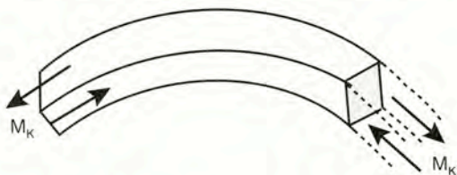
Σχήμα 10.2α Διατομή στρεφόμενη περί τον ουδέτερο άξονα 0-0.
