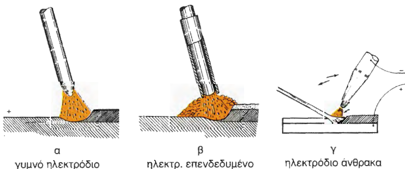
Εικ. 7.4β Συγκόλληση με ηλεκτρικό τόξο
