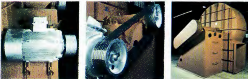
Εικ. 14.9.α Ιμαντοκίνηση παραδείγματος εφαρμογής
