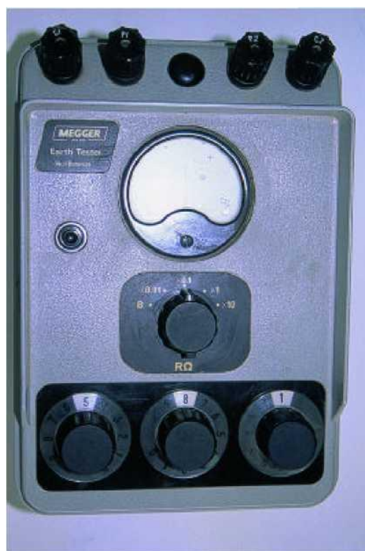
Εξωτερική όψη αναλογικού γειωσόμετρου
