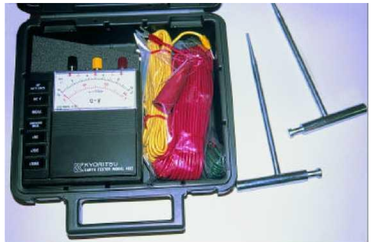
Όργανο μέτρησης της αντίστασης γείωσης
