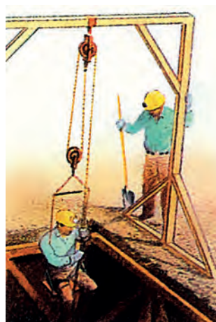
Εικόνα 5.9: Συνδυασμός ακίνητης και κινητής τροχαλίας(πολύσπαστο)
