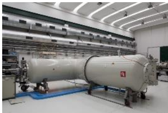
Επιταχυντής tandem για έρευνα υλικών και εργα τέχνης
